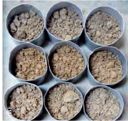
FIGURA 20 Análise das características do solo a diferentes profundidades Fonte: ALMEIDA, 2017.
